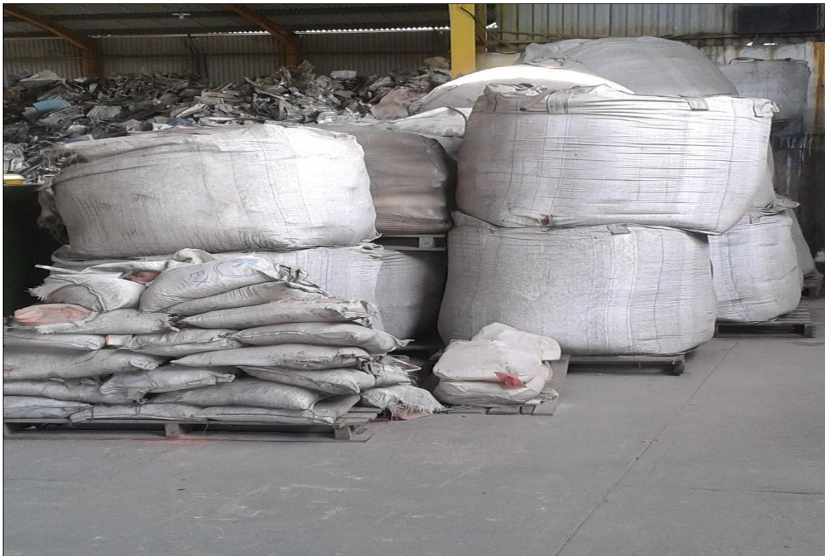
Cloruro de potasio utilizado para extraer aluminio de las escorias
