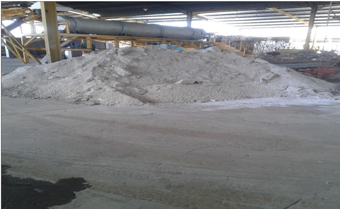
Cloruro de sodio utilizado para extraer aluminio de las escorias
