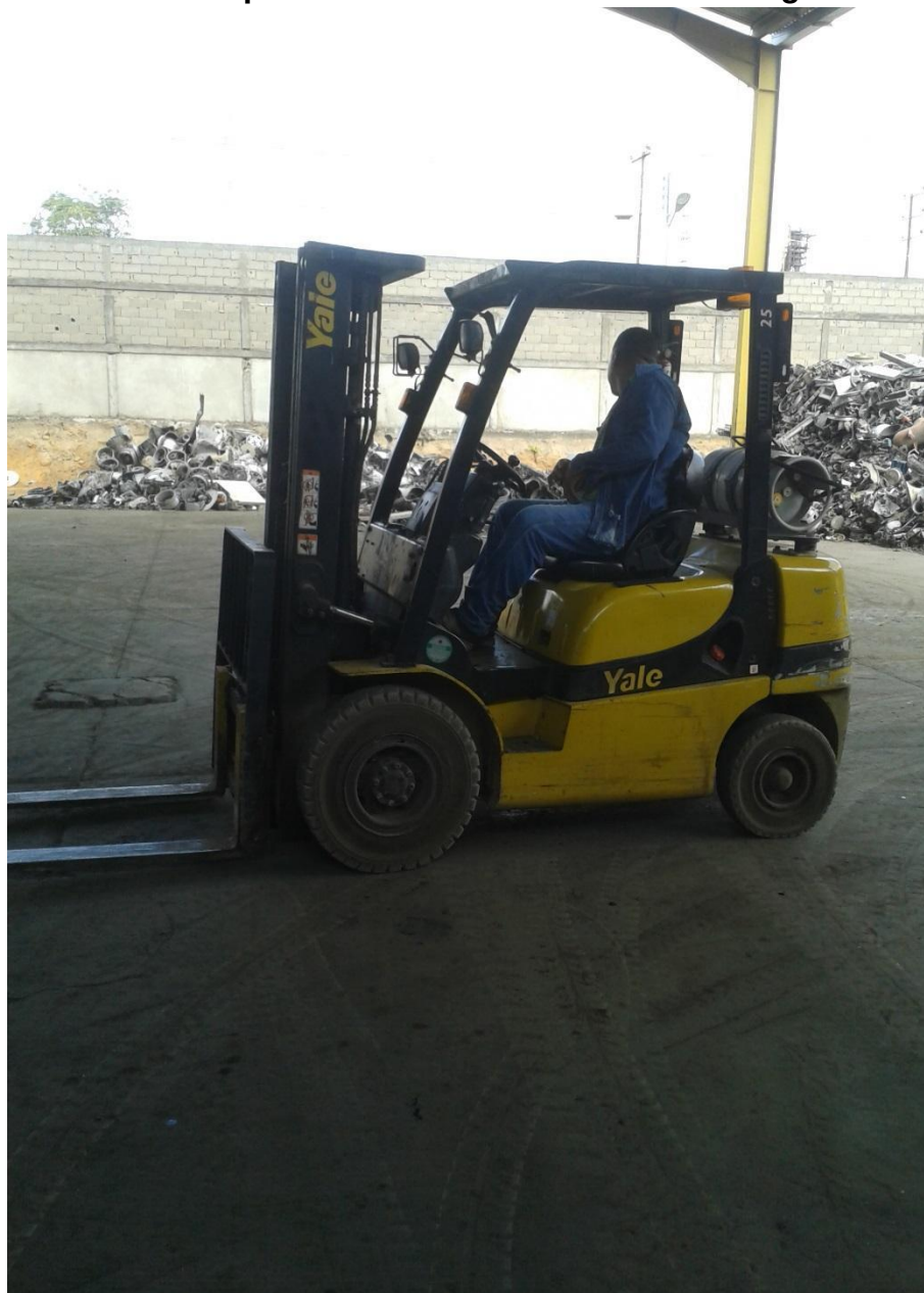
Montacarga Yale: Capacidad 3.000 Kg. Modelo: GTP25RK.
