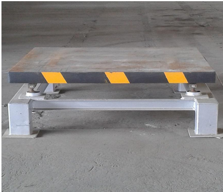
Balanza para peso de Carga de material y Producción: Balanza electrónica de 5.000 Kg.
