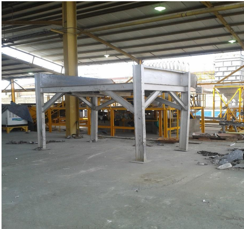
Mesa de Carga de Material, Alto 1.92 Mt, Ancho 2.60 Mt, Largo 2.40 m.
