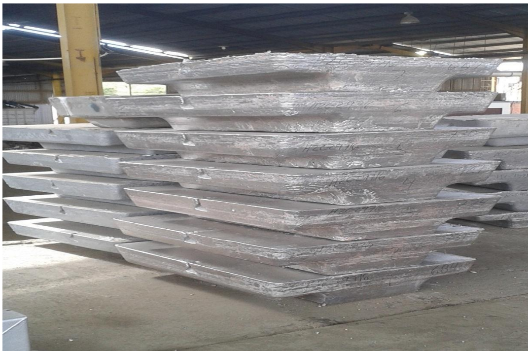
Producto fabricado: Lingotes tipo pailas de 680 Kg Aprox.
